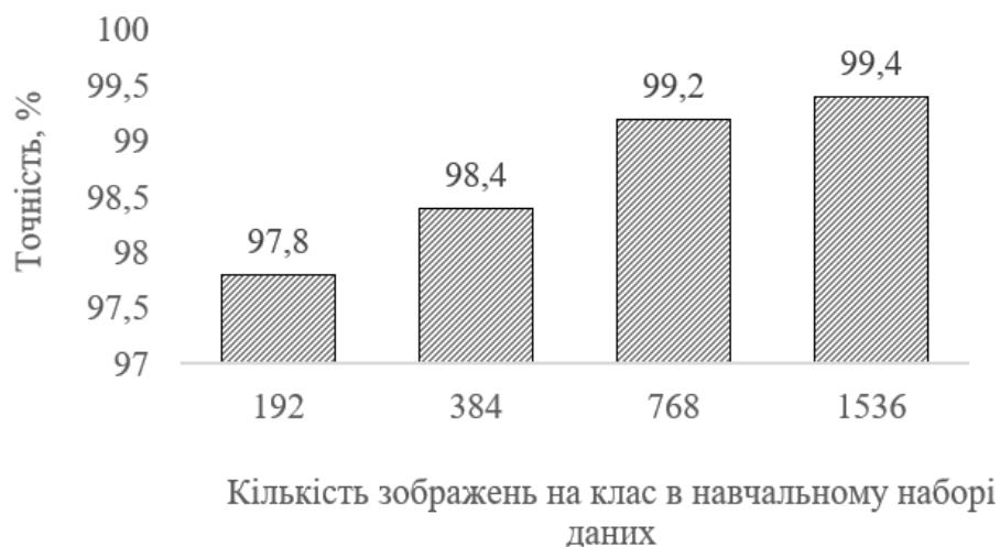
Рисунок 3. Приклад впливу розміру навчального набору даних на досягнуту точність розпізнавання (архітектура MobileNet)
