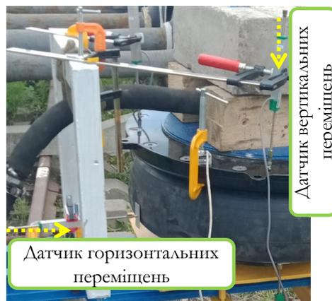
Рисунок 3. Схема розташування датчиків переміщень для вимірювання вертикальних та горизонтальних деформацій ресори
