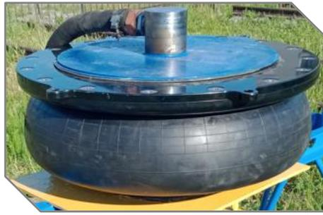
Рисунок 1. Пневматична ресора швидкісного рухомого складу
